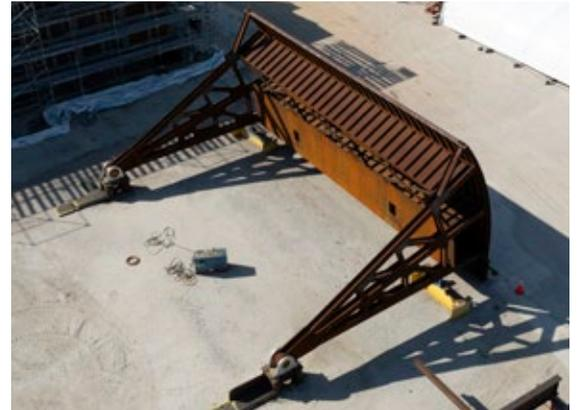
PB completó recientemente la fabricación de una compuerta de brazo radial que se entregará en barcaza por el río Misisipí a principios de 2025. Esta compuerta mide 60 pies de largo, 30 pies de alto y pesa 200,000 libras.
